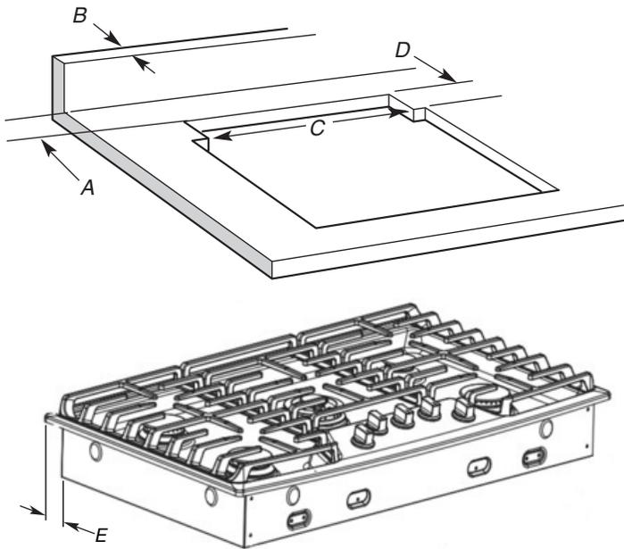
A.  $\frac{1}{2}$ " (12,7 mm) min. jusqu'au panneau anti-éclaboussure ou mur arrière
