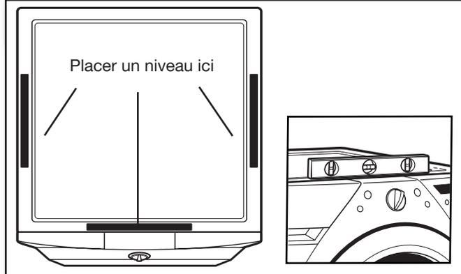
Placer un niveau aux bords supérieurs de la laveuse/sécheuse, en vérifiant chaque côté et le l'avant. Faire basculer l'appareil d'arrière en avant pour s'assurer que les quatre pieds sont fermement en contact avec le sol.
