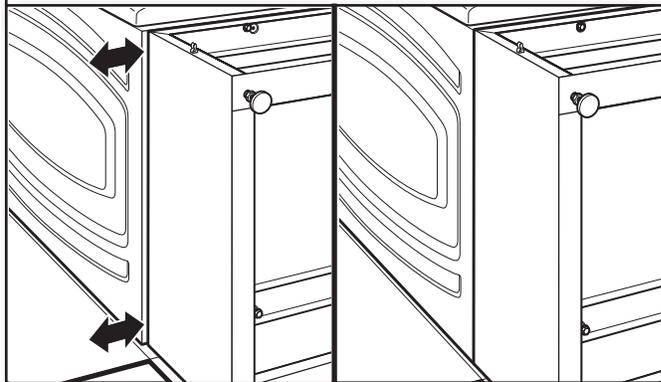
Aligner les bords du piédestal pour qu'ils soient en affleurement avec les bords de la laveuse/sécheuse. Bien serrer les quatre vis du piédestal (introduire le bras dans l'ouverture de passage du tiroir).
