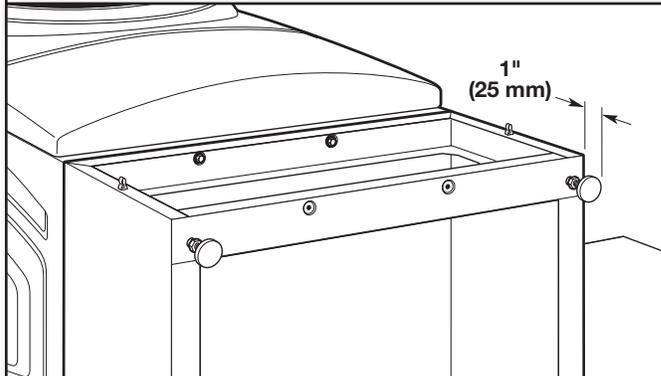
Le piédestal est fourni avec les pieds serrés contre la base de l'unité. À l'aide d'une clé à tête hexagonale de 1/4", ou d'une clé à molette, abaisser le pied d'environ 1" (25 mm) de la base du piédestal.
