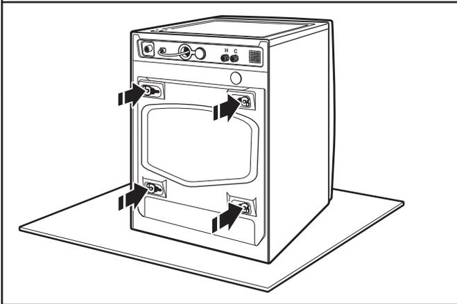
Repérer les boulons de transport à l'arrière de la laveuse. Les boulons de transport doivent rester dans la laveuse pendant l'installation du piedestal. Lorsqu'on couche la laveuse sur le dos, maintenir l'embout inférieur sur le sol. Ne pas enlever la pellicule de plastique, les coins protecteurs, ni l'embout supérieur.
