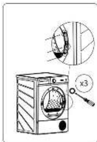
4. Retirar el cristal interior de la puerta
