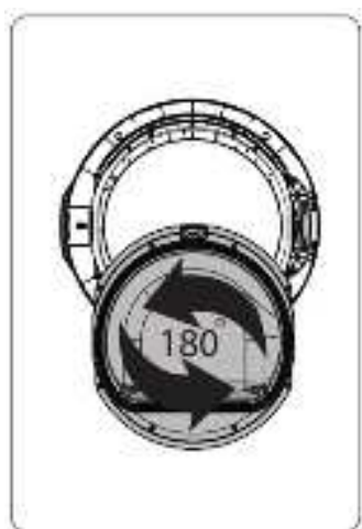
5. Gire la puerta 180 grados y vuelva a instalar el cristal interior
