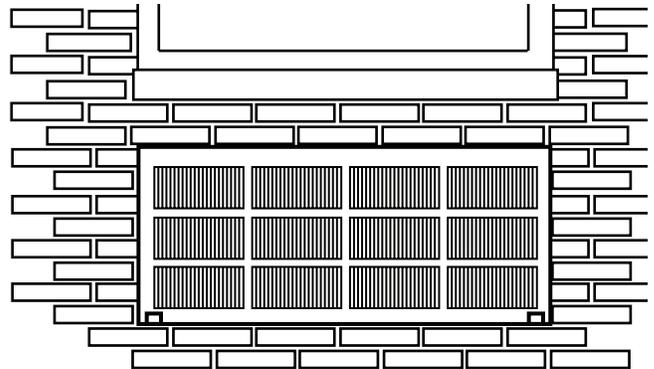
Le coffret est désormais prêt pour l'installation du châssis. (Pour installation du châssis et du devant de finition, voir les instructions emballées avec le châssis.)
