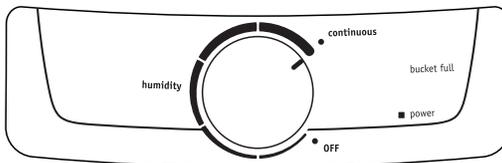
3. Después de un par de días cuando la Humedad Relativa ha declinado, rote el pulsador HUMEDAD al punto deseado en el dial para que el ambiente se mantenga a una concentración confortable. La unidad tendrá ciclos de encendido y de apagado para mantener el nivel de confort deseado.
