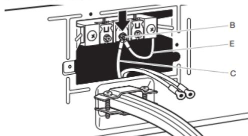
Connecter le conducteur neutre (E) et le conducteur neutre (blanc ou central) (C) du câble d'alimentation ou du câble sous la vis de la borne centrale (B). Serrer la vis.
