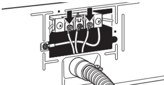
Placer les extrémités en crochet des conducteurs restants du câble pour raccordement direct sous les vis les plus à l'extérieur du bornier (crochets vers la droite). Rapprocher les extrémités du crochet et serrer les vis. Placer la languette du couvercle du bornier dans la fente du panneau arrière de la sècheuse. Fixer le couvercle avec la vis de retenue. Ensuite, aller à la section « Exigences concernant l'évacuation ».
