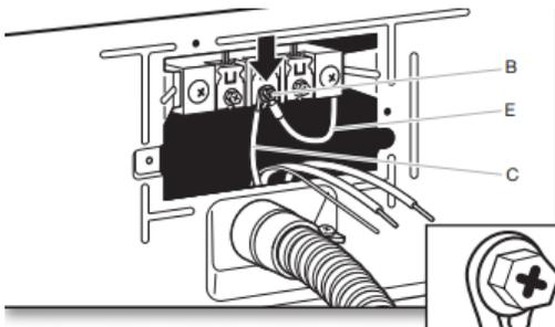
Connecter le conducteur neutre (E) et placer le crochet d'extrémité (crochet vers la droite) du conducteur neutre (blanc ou central) (C) du câble à raccordement direct sous la vis de la borne centrale (B). Rapprocher les extrémités du crochet et serrer la vis.
