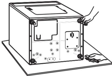
Afin d'éviter d'endommager le plancher, utiliser un grand morceau de carton plat extrait de la boîte d'emballage de la sècheuse et le placer sous toute la partie arrière de la sècheuse. Saisir fermement le corps de la sècheuse (et non pas le panneau de la console), puis reposer la sècheuse sur le carton avec précaution.
