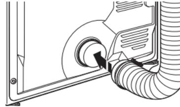
À l'aide d'une bride de fixation de 4" (102 mm), relier le conduit d'évacuation à la bouche d'évacuation de la sécheuse. Si on utilise le conduit d'évacuation existant, s'assurer qu'il est propre. Le conduit d'évacuation doit être fixé par-dessus la bouche d'évacuation de la sécheuse et à l'intérieur du clapet d'évacuation. S'assurer que le conduit d'évacuation est fixé au clapet d'évacuation à l'aide d'une bride de fixation de 4" (102 mm).
