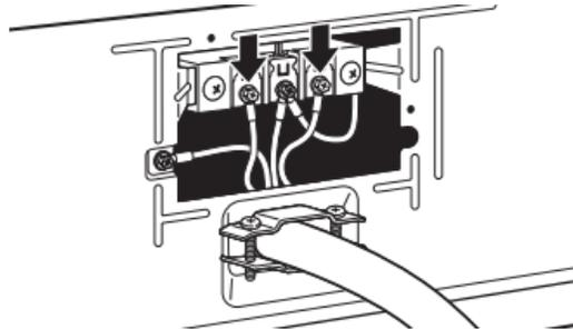
Connecter les conducteurs restants sous les vis les plus à l'extérieur du bornier. Serrer les vis. Placer la languette du couvercle du bornier dans la fente du panneau arrière de la sécheuse. Fixer le couvercle avec la vie de retenue. Ensuite, aller à la section « Exigences concernant l'évacuation ».
