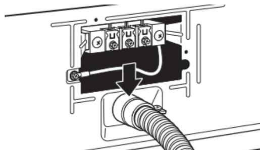
Passer le câble à raccordement direct à travers le serre-câbles. Le serre-câbles doit être bien relié à la caisse de la sécheuse et se trouver en position horizontale. Serrer la vis du serre-câbles autour du câble à raccordement direct.
