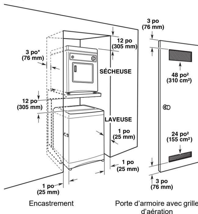
\* Espace supplémentaire recommandé. \*La plupart des installations requièrent un espace minimum de 5 1/2 po (140 mm) derrière la sècheuse pour le conduit d'évacuation avec coudes. Voir la section « Exigences concernant l'évacuation ».
