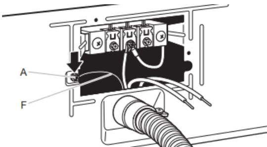
Connecter le conducteur (vert ou nu) de liaison à la terre (F) du câble pour raccordement direct sous la vis du conducteur de liaison à la terre externe (A). Serrer la vis.
