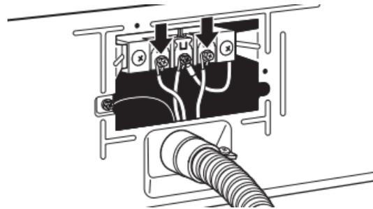
Placer les extrémités en crochet des conducteurs restants du câble pour raccordement direct sous les vis les plus à l'extérieur du bornier (crochets vers la droite). Rapprocher les extrémités du crochet et serrer la vis. Placer la languette du couvercle du bornier dans la fente du panneau arrière de la sécheuse. Fixer le couvercle avec la vis de retenue. Ensuite, aller à la section « Exigences concernant l'évacuation ».
