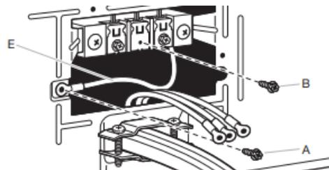
Installer le bon serre-câbles pour votre raccordement électrique. Retirer la vis de la borne centrale (B). Retirer le conducteur neutre (E) de la vis du conducteur de terre externe verte (A).
