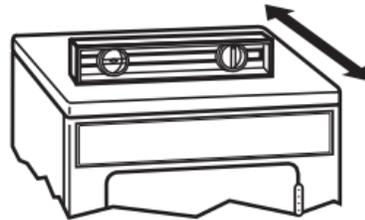
Contrôler l'aplomb transversalement, puis dans le sens avant/arrière.
