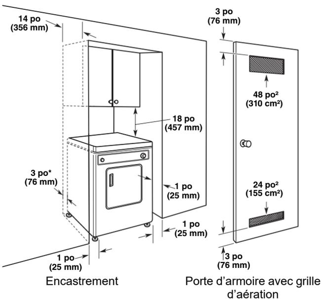
**Installation dans un encastrement ou une armoire – superposition**
