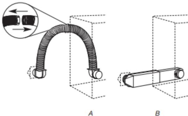
A. Installation au-dessus de la sècheuse (également offerte avec un coude décalé)
