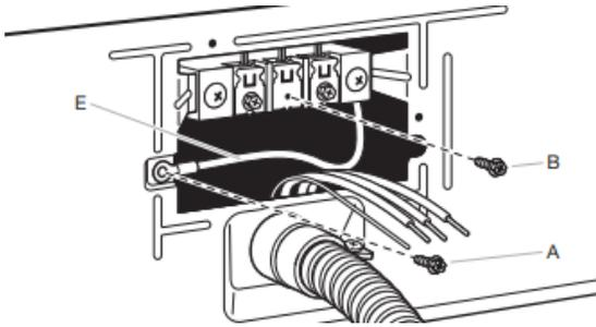
Retirer la vis de la borne centrale (B). Retirer le conducteur neutre (E) de la vis du conducteur externe verte (A).
