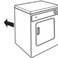
Placer la sécheuse à son emplacement final. Éviter d'écraser ou de déformer le conduit d'évacuation.
