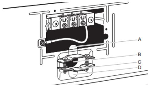
Retirer les vis d'un serre-câbles homologué UL de 3/4 po (19 mm) UL (inscription UL sur le serre-câbles). Placer les languettes des deux moitiés de pince (C) dans le trou sous l'ouverture du bornier (B), de sorte qu'une d'entre elles pointe vers le haut (A) et l'autre vers le bas (D). Maintenir en place. Serrer les vis du serre-câbles juste assez pour maintenir ensemble les deux moitiés de pince (C).
