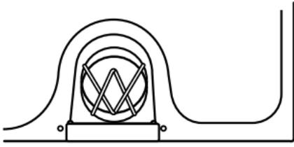
Avant d'installer le conduit d'évacuation, s'assurer de retirer le protecteur en fil métallique qui est situé à la sortie d'évacuation.
