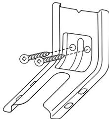
5. Utiliser un tournevis cruciforme pour viser la bride antibasculement au mur ou au plancher à l'aide de deux vis no 12 x 1 5/8 po (4,1 cm) incluses.
