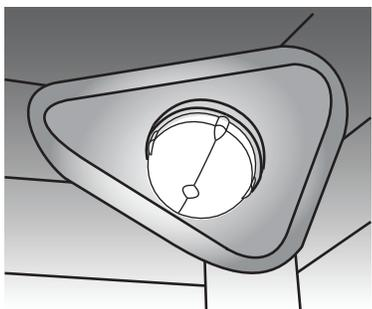
Figure 42 : Ampoule halogène du four encastré
