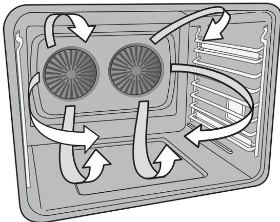
Figure 20 : Circulation de l'air en mode convection
