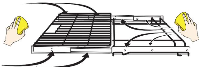
3. Agitez vigoureusement le lubrifiant graphite avant l'application. Déposez 4 gouttes de lubrifiant graphite sur la glissière (voir les zones encadrées plus bas). Répétez des deux côtés de la grille extensible.
