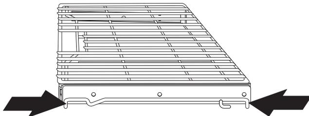
8. Remplacez la grille à l'endroit et insérez-la dans le four.
