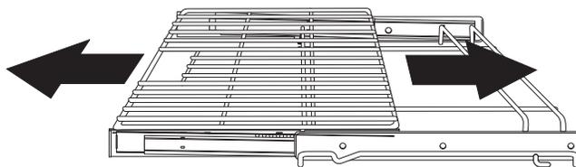
5. Retournez la grille. Agitez vigoureusement le lubrifiant graphite avant l'application. Déposez 4 gouttes de lubrifiant graphite sur la glissière. Répétez des deux côtés de la grille extensible.
