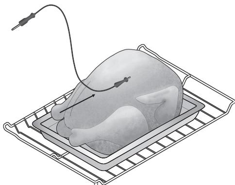
Figure 28 : Positionnement correct de la sonde
