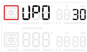
Figure 29 : Température du four supérieure de 30° à la température par défaut
