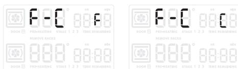
Figure 14 : Sélection des degrés Fahrenheit ou Celsius
