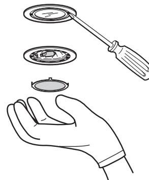
3. Enlever la lampe. Installer une lampe à halogène neuve de 120 V/40 W maximum, à culot de type G-9.
