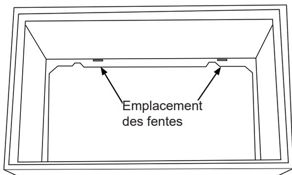
Insérez les pattes du haut de la grille dans les deux fentes du rebord arrière. Assurez-vous que les deux pattes sont dans les fentes et visibles de l'intérieur du boîtier.
