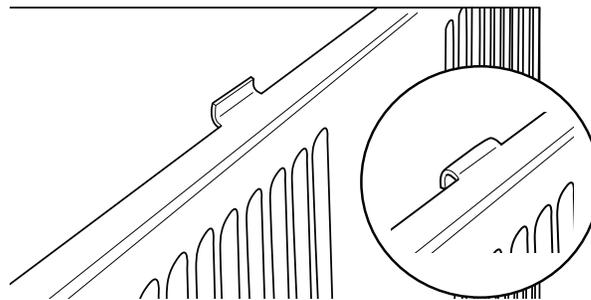
2. Installez les attaches de type S sur le rebord supérieur arrière du boîtier à environ 20,32 cm (8 po) de chaque côté. Les attaches se fixent à travers les trous du rebord.
