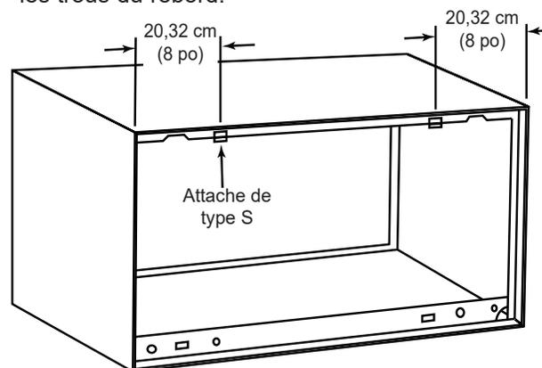
3. À l'aide le ruban, passez la grille à travers le boîtier pour qu'elle soit à l'extérieur. Tirez-la ensuite contre l'arrière du boîtier et insérez le haut de la grille sur les attaches.
