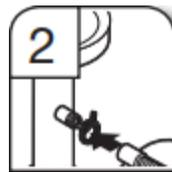
2. Fixer l'extrémité du tuyau d'évacuation en caoutchouc à la canalisation d'égout en T à l'aide d'une grosse bride pour tuyau d'évacuation (fournie). À l'aide de pinces, serrer la bride pour l'ouvrir et la mettre en position. Si le tuyau d'évacuation a été coupé, utiliser une bride à vis de 1 1/2" (38 à 50 mm) (non fournie).
