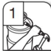
1. À l'aide d'un marteau et d'un tournevis, enfoncer le bouchon d'obturation dans le broyeur à déchets.
