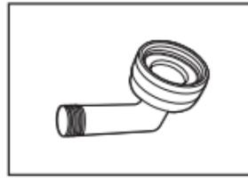
**Racor de manguera con conexión de compresión de 3/8" (9,5 mm) x 3/4" (19 mm)** con junta de goma y codo de 90° (necesario para conectar de forma adecuada la tubería de agua del hogar a la lavavajillas)
