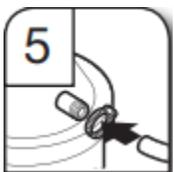
5. Utiliser un tuyau en caoutchouc (non fourni) et une bride à vis (non fournie) pour le raccordement du dispositif de brise-siphon à l'entrée du broyeur à déchets.
