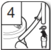
4. Fixer le tuyau d'évacuation sur le dispositif de brise-siphon à l'aide de la grosse bride de tuyau d'évacuation (fournie). À l'aide de pinces, serrer la bride pour l'ouvrir et la mettre en position. Si le tuyau d'évacuation a été coupé, utiliser une bride à vis de 1 1/2" (38 à 50 mm) (non fournie).
