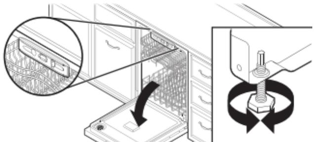
Placer le niveau contre la partie supérieure de l'ouverture avant de la cuve. Vérifier l'aplomb transversal de l'appareil. Si le lave-vaisselle n'est pas d'aplomb, régler la hauteur des pieds avant vers le haut ou vers le bas jusqu'à ce que le lave-vaisselle soit d'aplomb.
