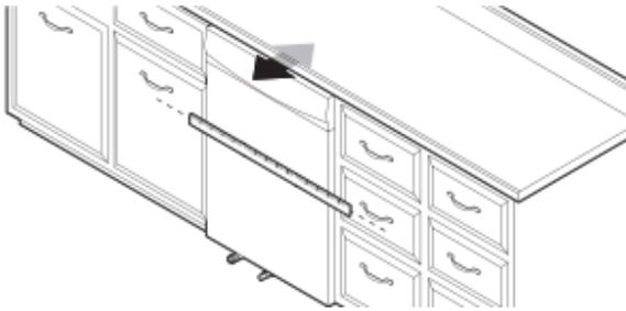
Aligner l'avant du panneau de porte du lave-vaisselle avec les portes des armoires. Il faudra peut-être ajuster l'alignement de celui-ci pour qu'il soit en affleurement avec les armoires.
