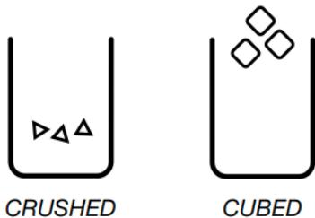
Para obtener hielo picado, los cubos de hielo se trituran antes de despacharse. Esto puede retrasar un poco el despacho del hielo picado. El ruido proveniente del triturador de hielo es normal, y los trozos de hielo pueden variar en tamaño. Cuando cambie de hielo picado a hielo en cubos, caerá un poco de hielo picado junto con los primeros cubos.
