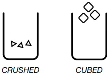
Pour de la glace concassée, les glaçons sont concassés avant d'être distribués. Cette action peut causer un court délai lors de la distribution de glace concassée. Le bruit du broyeur de glaçons est normal et la dimension des morceaux de glace peut varier. Lorsqu'on passe du mode glace concassée au mode glaçons, quelques onces de glace concassée sont distribuées avec les premiers glaçons.
