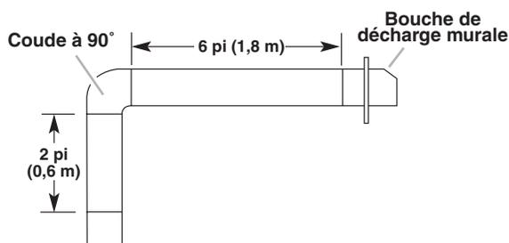
L'exemple suivant ne dépasse pas la longueur de conduit maximale recommandée.
