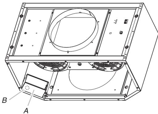
A. Boîtier de raccordement électrique
