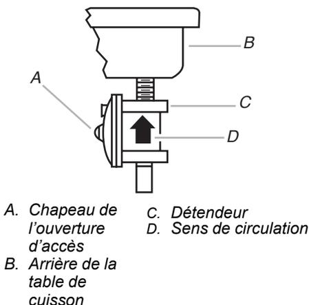
3. Déterminer le type de détendeur :
