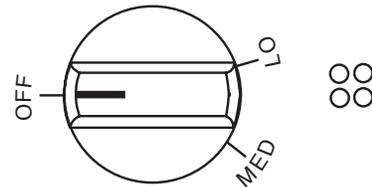
2. Si le brûleur ne s'allume pas correctement, tourner le bouton de commande à Off (arrêt). Veiller à ce que le chapeau de brûleur soit à la position correcte.
