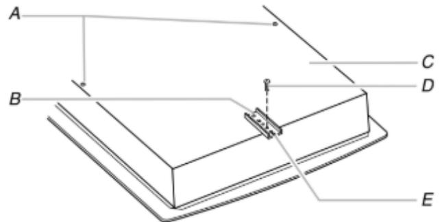
A. Trous de vis d'attache pour emplacement facultatif à l'avant et à l'arrière
