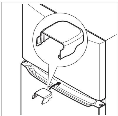
12. Alinee la bisagra superior con los orificios de la unidad y fije los tornillos con una llave de 5/16" , luego coloque la cubierta de la bisagra superior en la unidad (algunos modelos).
