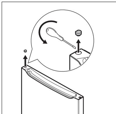
2. Coloque la cubierta en el rodamiento superior derecho de la puerta del refrigerador y tire de él.
