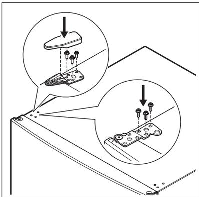
13. Vuelva a colocar la cubierta de la bisagra inferior.
