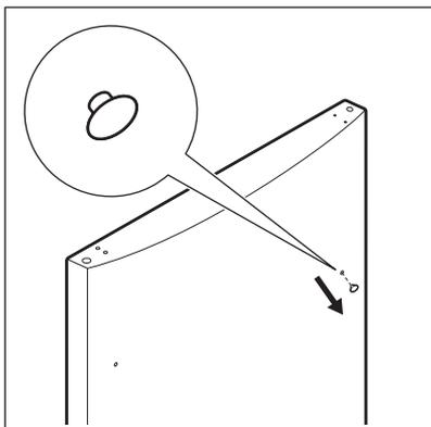
2. Retire el tornillo con una llave ajustable o un destornillador de múltiples puntas (varía según el modelo) e instálelo donde se retiraron los tapones de botón en el lado opuesto de la puerta.
