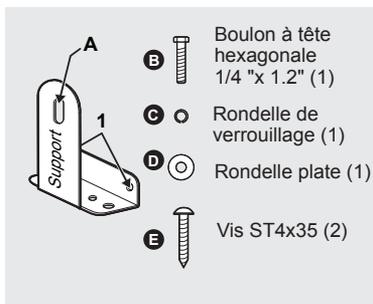
1. Après avoir choisi l'emplacement pour l'installation, placez le support sur le plancher avec (1) contre le mur, en utilisant les deux vis (E) pour fixer le support au mur. Assurez-vous qu'il y a au moins une vis fixée dans un goujon.
