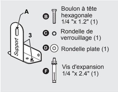
1. Après avoir choisi l'emplacement pour l'installation, utilisez un ou l'autre trou (3) pour fixer le support au plancher de béton.
