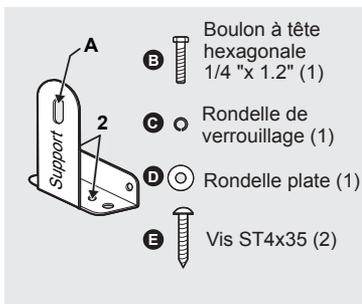
1. Après avoir choisi un emplacement pour l'installation, placez le support sur le plancher de bois. Serrez-vous des deux vis (E) pour fixer le support au plancher en utilisant les trous du support (2).
