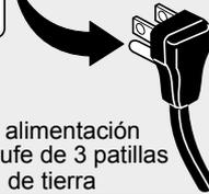
Cable de alimentación con enchufe de 3 patillas con toma de tierra
