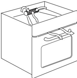
Figure 6: Ubicación del ventilador de refrigeración
