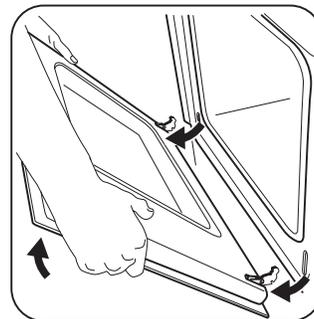
Figure 24: Sujeción de la puerta para su extracción
