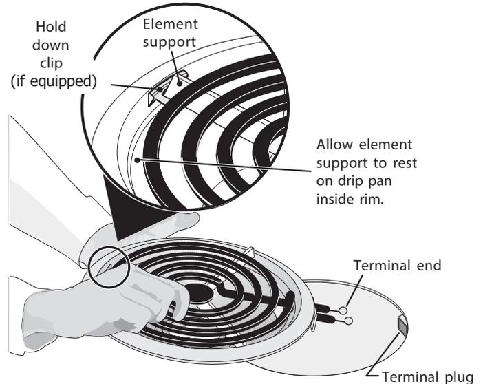
Figure 20: Extracción de serpentín y platillos protectores
