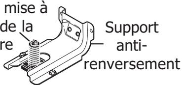
Pour vérifier si le support anti-renversement est correctement installé, attrapez le bord arrière de la cuisinière à deux mains, et essayez doucement de faire basculer la cuisinière vers l'avant. Lorsque le support est correctement installé, la cuisinière ne doit pas basculer vers l'avant.
