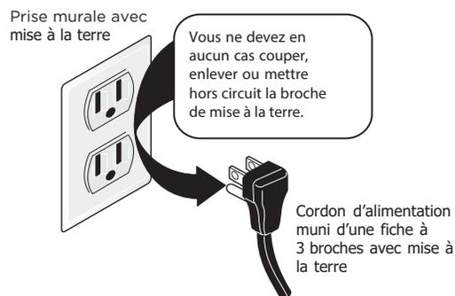
Cet appareil est muni d'une fiche à trois broches avec mise à la terre pour assurer votre protection contre les chocs électriques. Cette fiche doit être branchée directement dans une prise correctement mise à la terre. N'enlevez pas la broche de mise à la terre de cette fiche.
