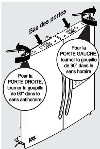
Une fois que les goupilles de la porte sont réenclenchées, suivez les étapes de la section « Pour réinstaller les portes du réfrigérateur ».
