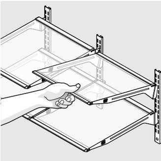
3. La replacer en insérant les crochets du support de montage dans les fentes de support souhaitées.
