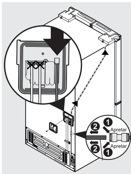
5. Extraiga el tubo de agua del conducto de la parte superior del compartimento.
