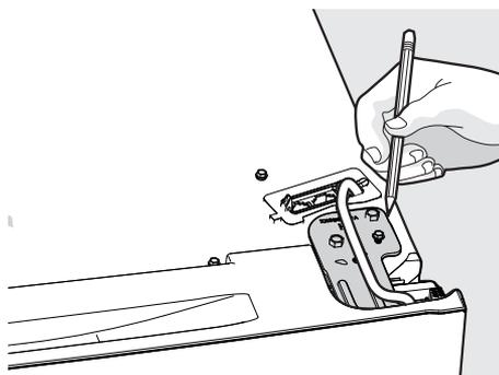
4. Retire la tapa de la mampara en la parte trasera de la unidad para acceder a la tubería de agua. Desconecte el tubo de agua en la conexión de bloqueo a presión en la parte trasera de la unidad debajo de la mampara. La tubería del dispensador está conectada a la tubería de agua amarilla que proviene de la válvula de agua principal.
