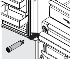
Si no utilizó el refrigerador por un tiempo (durante una mudanza, por ejemplo), cambie el filtro antes de reinstalar el refrigerador.
