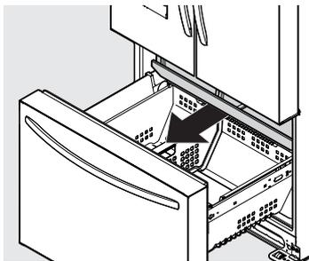
3. Empuje ligeramente hacia adentro las lengüetas de la canasta para liberar la canasta superior de los montajes de la corredera (1 por lado, en el frente).
