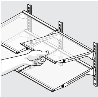
3. Para volver a colocarlo, inserte los ganchos de los soportes de montaje en las ranuras de soporte deseadas.
