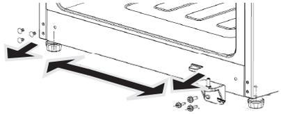
5. Desenrosque las clavijas de ambas bisagras y transfíralas al orificio roscado del lado opuesto. Vuelva a instalar la bisagra inferior en la esquina izquierda del gabinete utilizando los tres tornillos quitados en el paso 4.
