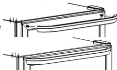
2. Utilice un destornillador de cabeza hexagonal o llave Allen para ajustar los tornillos de la parte inferior para asegurar la manija a la puerta.
