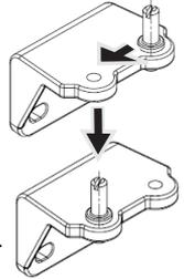
6. En el borde inferior de la puerta, transfiera la boquilla y el soporte de detención de la puerta a los orificios del lado opuesto.
