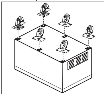
5. Después de instalar las ruedas, con la ayuda de un asistente, levante y gire cuidadosamente el congelador y colóquelo en posición vertical. Mueva el congelador al lugar deseado y active los frenos.
