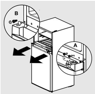
4. Desatornille los tornillos de la bisagra inferior en el lado derecho y las patas de ajuste en ambos lados.
