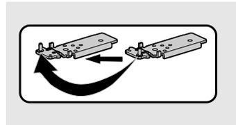
6. Instale la bisagra inferior en el lado izquierdo y apriete los tornillos. Instale las dos patas de ajuste en ambos lados y coloque el refrigerador en posición vertical.
