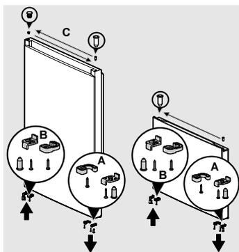
8. Baje la puerta del refrigerador en la posición abierta sobre la bisagra inferior.
