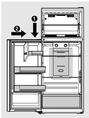
9. a. Instale la bisagra central con los tornillos de la bisagra y el tapón de la bisagra en el lado izquierdo.
