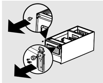
5. Retire el pasador de la bisagra inferior y vuelva a instalarlo en el orificio en el lado opuesto de la bisagra.
