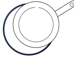
El recipiente de cocción no está centrado en la superficie del elemento de cocción.
