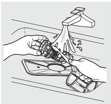
5. Vuelva a montar los filtros en el orden inverso al desmontaje; sustituya el cartucho de filtro y gírelo en el sentido de las agujas del reloj y de la flecha de cierre.
