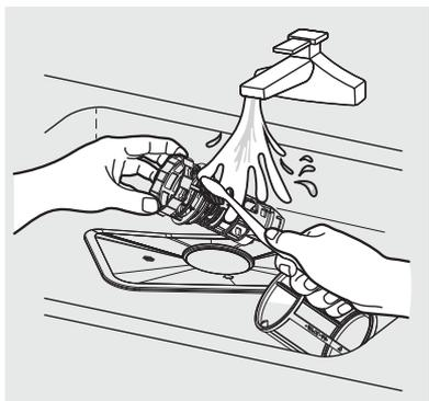
5. Remontez les filtres dans le sens inverse du démontage, remplacez la cartouche filtrante et tournez dans le sens horaire vers la flèche de fermeture.
