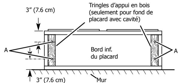
A. 4 vis à bois à tête plate ou vis à métaux avec rondelles et écrous
