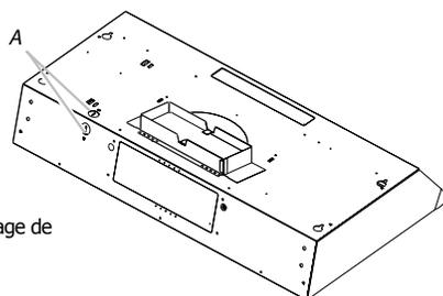
4. À l'aide d'au moins deux personnes, soulever la hotte et la placer à son emplacement final. Insérer suffisamment de câble électrique à travers le serre-câble de 1/2" (homologation UL ou CSA) pour établir les connexions avec la boîte de connexion. Serrer les vis du serre-câble.
