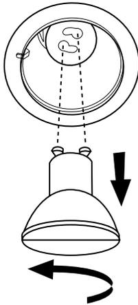
3. Retirer l'ampoule et la remplacer par une ampoule halogène de 120 volts, 50 watts maximum avec culot GU10. La tourner dans le sens horaire pour l'emboîter.
