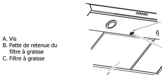
2. Pour retirer la patte de retenue, la tirer vers l'avant de la hotte et tirer le rebord avant du filtre vers le bas.
