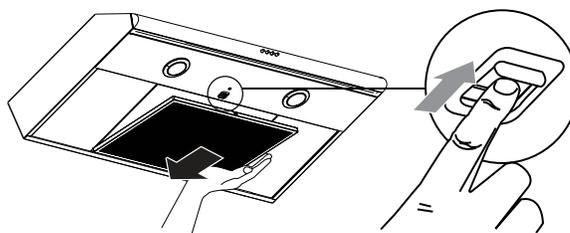
3. Pour nettoyer le filtre à graisse, faire tremper les filtres dans l'eau chaude avec un détergent doux. Rincez bien et secouez-le pour sécher. Ou dans le panier supérieur du lave-vaisselle à nettoyer.
