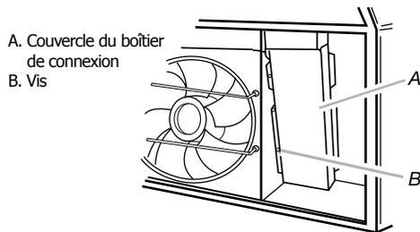
3. Ôter l'opercule pour le passage de l'alimentation électrique du sommet ou de l'arrière de la hotte de ventilation (selon l'emplacement du point d'entrée du câble d'alimentation du domicile) et installer un serre-câble de 1/2" homologué UL ou CSA.
