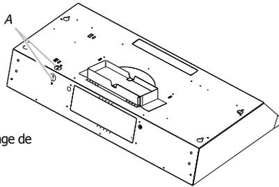
A. Opercule pour le passage de l'alimentation électrique
