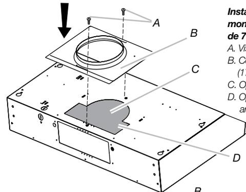
Installer une plaque de montage de conduit rond de 7" (17,8 cm)
