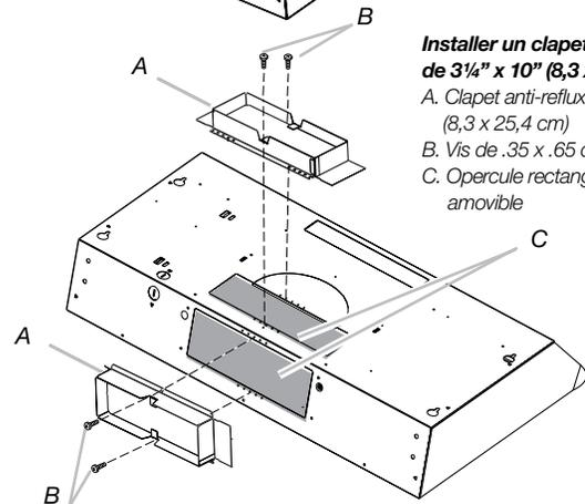
Installer un clapet anti-reflux de 3¼" x 10" (8,3 x 25,4 cm)
