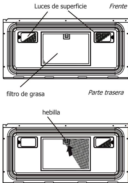
1. Para extraer el filtro de grasa, tire de la palanca y, a continuación, tire del filtro hacia abajo. El filtro se caerá.
