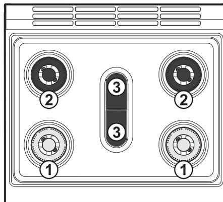
La plaque de cuisson est équipée de trois types de brûleurs différents, qui doivent être placés dans leur logement respectif correct :
