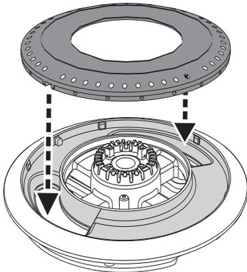
3. Le couvercle du brûleur doit être nivelé et centré par rapport au dossieret du brûleur.
