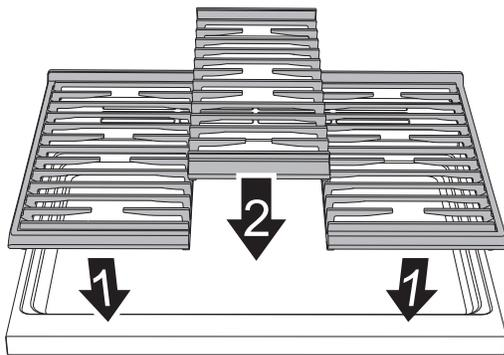
Coloque las rejillas de manera que la parte levantada siempre esté orientada hacia el respaldo.
