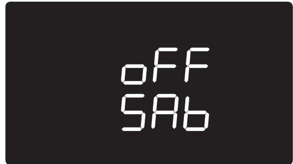
En este estado, el horno no generará calor pero la función de Sabbath permanecerá activa. Esta pantalla permanecerá así indefinidamente hasta que gire el mando de modo del horno. Cuando gire el mando de modo del horno, la pantalla mostrará la hora.
