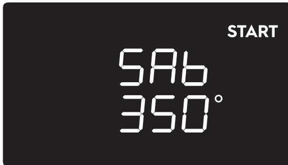
3. Presione y gire una vez la perilla de la temperatura del horno para cambiar la temperatura (el símbolo de los grados empieza a parpadear).
