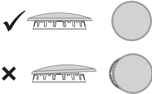
Instalación de los componentes del quemador de pescado:
