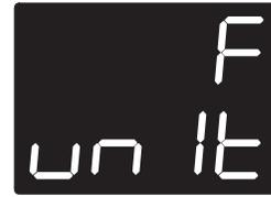
Al girar hacia la derecha la perilla de la temperatura, la pantalla cambia entre °C y °F.
