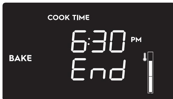
Al girar y soltar la perilla del modo horno a la izquierda, o después de esperar unos segundos, la pantalla cambiará a pantalla en espera (solo hora actual) mientras que la barra de descenso de la temperatura indicará que la cavidad del horno sigue estando caliente.
