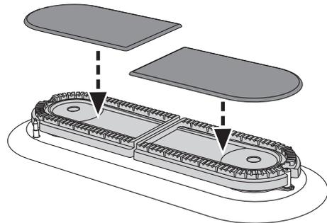
3. Compruebe visualmente que las cubiertas de los quemadores estén colocadas correctamente.
