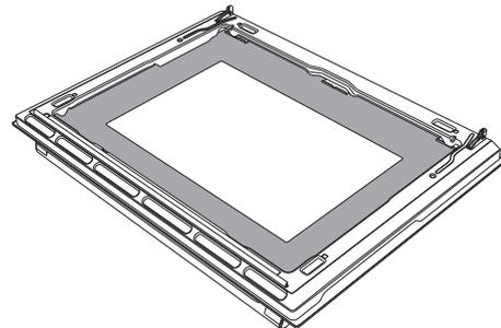
4. Vuelva a colocar los vidrios siguiendo la secuencia del desmontaje en forma inversa. Vuelva a posicionar el vidrio interior. Centre e inserte cuidadosamente los 4 pernos en sus ranuras en la puerta del horno ejerciendo una
