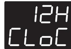
Al girar la perilla de la temperatura hacia la derecha, la pantalla cambia entre el formato de 12 horas (con la indicación AM/PM) y el formato de 24 horas.
