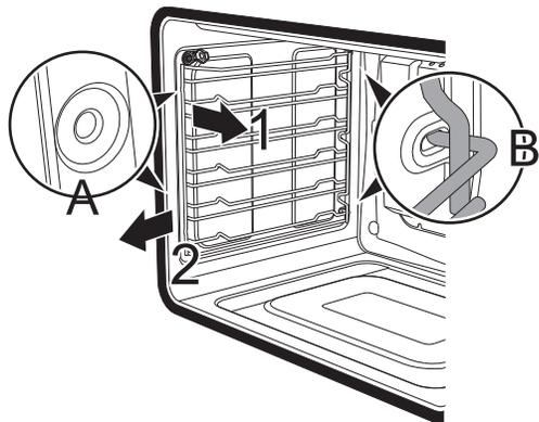
1. Una vez completada la limpieza, repita los pasos anteriores para volver a colocar los soportes de los estantes.
