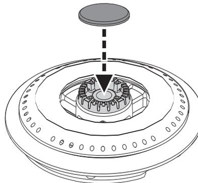
Chaque composant du brûleur doit être positionné horizontalement et doit s'emboîter correctement. Vérifiez qu'ils soient correctement montés en déplaçant doucement chaque composant. Si les composants ne s'adaptent pas correctement ou sont inclinés, ajustez la position de chaque composant jusqu'à ce qu'il reste fixé en position.
