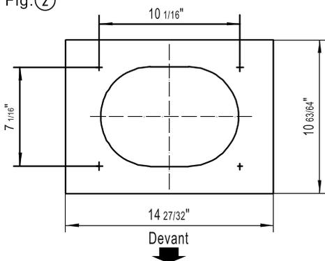
⚠ **NOTE:** Ne coupez pas l'ouverture du conduit indiquée sur le gabarit pour l'installation de recirculation.
