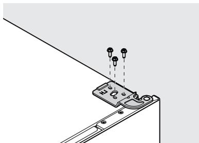
Si le transport de votre unité nécessite le retrait de la porte, vous devez avoir un écart de porte uniforme de 9 mm autour du périmètre de l'armoire pour assurer un joint d'étanchéité adéquat afin d'éviter le gel dans le congélateur. Mesurez l'espace de 9 mm entre le métal de l'armoire et le métal de la porte.
