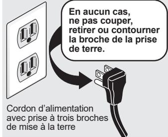
Utiliser une prise électrique double de type mise à la terre dédiée pour chaque unité (c.-à-d. deux prises doubles, chacune sur un circuit électrique dédié) pour une configuration d'unité appariée.
