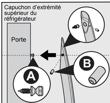
Garantir la Poignée Vis Fixes se Font face à avec les Portes Fermées.
