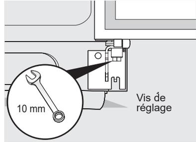
4. Remettez la vis d'arrêt en place, afin de verrouiller la hauteur de la porte.
