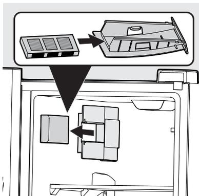
Vous devriez changer votre filtre à air tous les 6 mois (le voyant lumineux d'état du filtre sur le panneau de commande vous rappelle de remplacer le filtre au bout de 6 mois) pour réduire au maximum les odeurs dans le réfrigérateur. Les différents aliments produisent des odeurs à des degrés différents. Installation de votre nouveau filtre à air **PAULTRA2<sup>MC</sup> PureAir Ultra II :**
