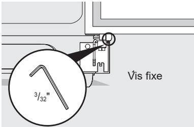
2. Si la porte du congélateur est plus basse que celle du réfrigérateur (A) ou si la porte du réfrigérateur est plus basse que la porte du congélateur (B), soulevez la porte en tournant la vis de réglage dans le sens des aiguilles d'une montre à l'aide d'une clé de 10 mm.
