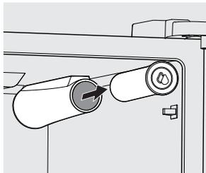
Il n'est pas nécessaire de couper l'alimentation en eau pour changer le filtre. Soyez prêt à essuyer de petites quantités d'eau durant le remplacement du filtre.
