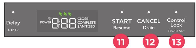
10. La Status Window (Fenêtre de statut) affiche le temps restant dans le cycle, le réglage du délai ou le rappel de « fermeture de la porte ».
