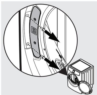
3. Retire ambos tornillos del pestillo de la puerta. Guarde el pestillo y los tornillos para volver a instalarlos más tarde.
