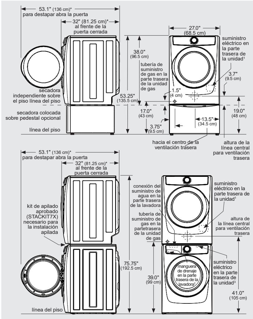
\* La conexión de la manguera de entrada de agua en la secadora de vapor agrega 3/4 in (2 cm) a la profundidad de instalación.
