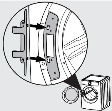
2. Vuelva a instalar y apriete los cuatro tornillos retirados anteriormente: los dos tornillos delanteros primero y luego los dos tornillos laterales.
