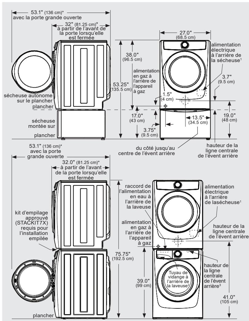
\* Le raccordement du tuyau d'admission d'eau de la sécheuse à vapeur ajoute 3/4 po (2 cm) à la profondeur d'installation.
