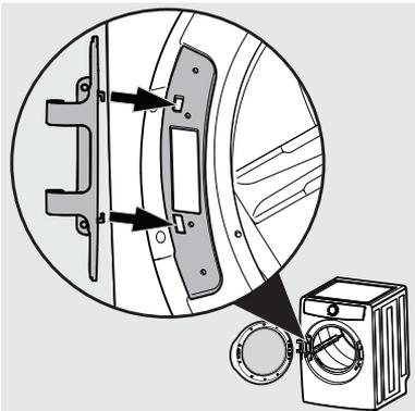
2. Réinstallez les quatre vis retirées précédemment et serrez-les : d'abord les deux vis avant, puis les deux vis latérales.
