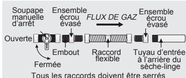
3. Ouvrez la soupape d'arrêt de la conduite d'alimentation en gaz pour permettre au gaz de circuler dans le tuyau. Attendez quelques minutes pour que le gaz se déplace dans la conduite de gaz.
