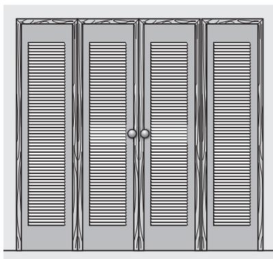
Portes à persiennes pliantes à deux vantaux avec ventilation de 120 po<sup>2</sup>
