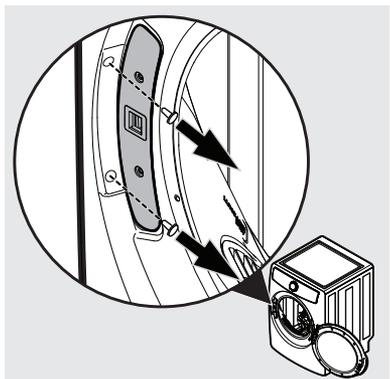
3. Retirez les deux vis du loquet de la porte. Conservez le loquet et les vis pour les réinstaller plus tard.
