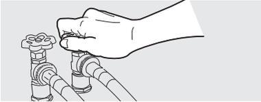
2. Retirez le tuyau d'entrée d'eau FROIDE de l'alimentation en eau FROIDE et inspectez la rondelle en caoutchouc. Remplacez la rondelle si elle est déchirée ou usée.
