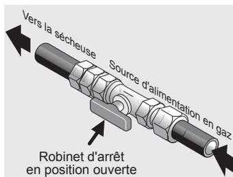
4. Vérifiez la présence de fuites du système de gaz à l'aide d'un manomètre. Si aucun manomètre n'est disponible, testez tous les raccords en brossant avec une solution d'eau savonneuse.
