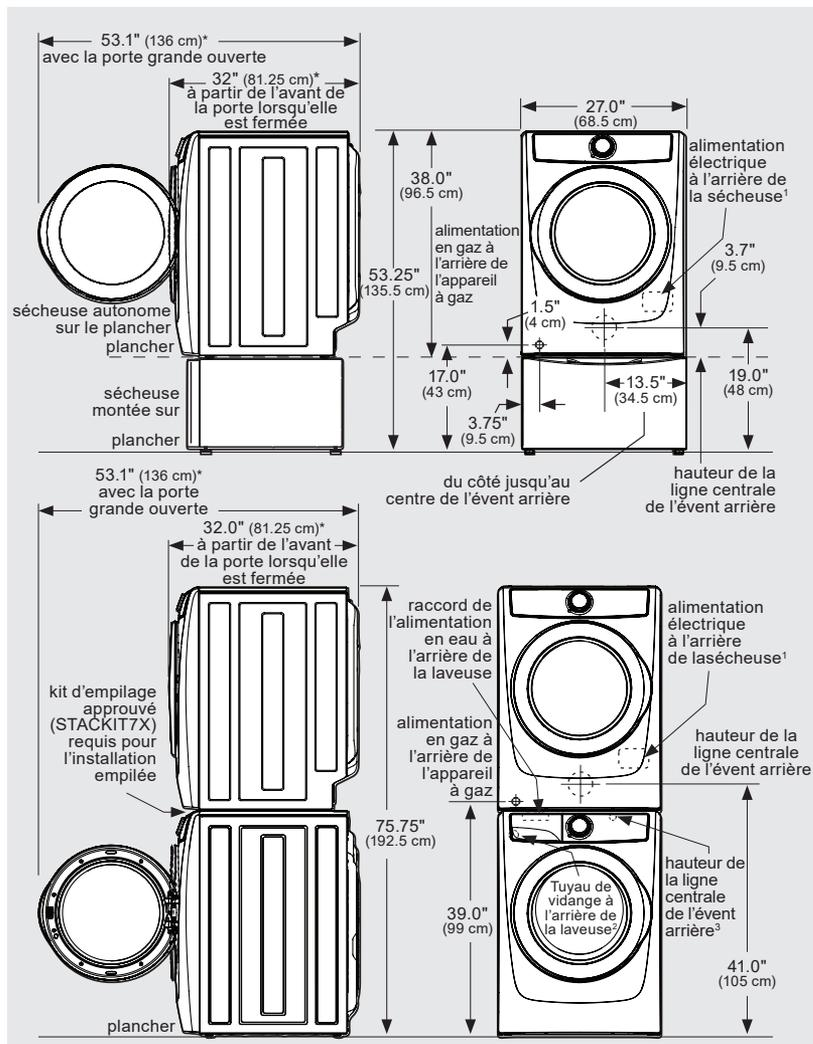
\* Le raccordement du tuyau d'admission d'eau de la sècheuse à vapeur ajoute 3/4 po (2 cm) à la profondeur d'installation.
