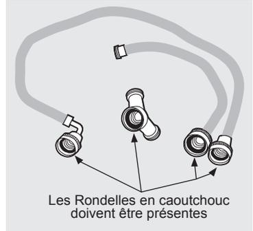
5. Si votre installation offre suffisamment d'espace pour que l'alimentation en eau FROIDE accepte directement le raccord en « Y », vissez le raccord en « Y » sur l'alimentation en eau FROIDE et serrez-le à la main, puis serrez-le de nouveau de 2/3 de tour avec des pinces.
