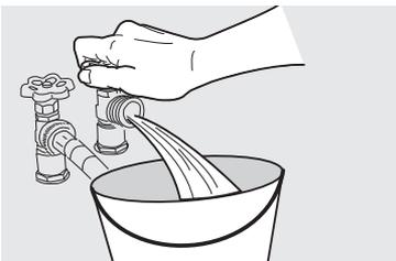
4. Inspeccione los acoplamientos de las mangueras para verificar la colocación correcta de las arandelas de caucho. Utilice las mangueras del
