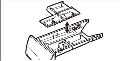
4. Rincez le tiroir et ses éléments de fixation avec de l'eau chaude du robinet pour éliminer les traces des poudres et liquides accumulés. Une quantité importante de résidus d'assouplisseur peut être le signe d'une mauvaise dilution ou de la nécessité d'effectuer un nettoyage plus fréquent.
