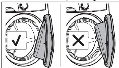
3. Branchez la machine à laver, puis fermez la porte. Contrôlez le verrouillage correct de la porte en lançant un cycle d'essai : le verrou doit s'enclencher et la porte ne doit pas pouvoir être ouverte avant l'interruption ou l'annulation du cycle.
