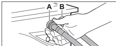
L'entrée d'eau froide est représentée sur le côté gauche (modèles 400, 500, 600, 700 uniquement). Sur les séries 300, l'entrée d'eau froide se trouve sur le côté droit.
