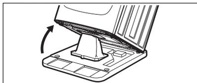
3. Remplacez soigneusement la machine à laver en position verticale.
