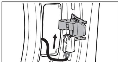
2. Faites glisser le capuchon de borne sur l'arrière de la plaque de la charnière jusqu'à ce que les languettes s'enclenchent en place.
