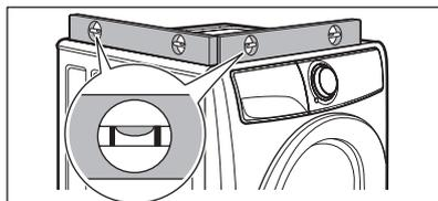
2. Utilisez une clé à molette pour régler les pieds de nivellement de manière à ce que la machine à laver soit au niveau à l'avant comme à l'arrière et des deux côtés, et que tous les coins soient stables.
