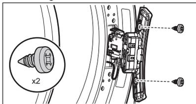
3. Débranchez la borne du faisceau de câblage du loquet de la porte. Mettez la serrure de la porte de côté pour la réinstaller ultérieurement.
