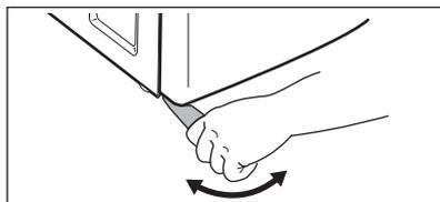
3. Appuyez sur les coins et les côtés les uns après les autres pour détecter le moindre mouvement. Réglez le(s) pied(s) concerné(s) de manière à ce que les quatre pieds de la machine à laver reposent fermement au sol. Gardez les pieds de nivellement au minimum pour optimiser les performances de la machine à laver.
