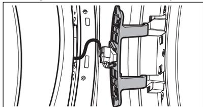
3. Insérez les tiges de positionnement de la charnière dans le trou précédemment recouvert par le cache en plastique. Appuyez sur l'avant de la charnière pour enclencher les autres tiges de positionnement en place.
