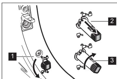
Pour désengager le support, faites-le tourner pour le déverrouiller, poussez-le vers l'intérieur et faites-le tourner en position verrouillée.
