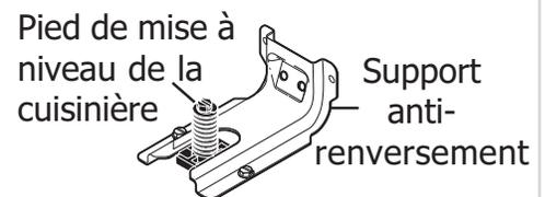
Pour vérifier si le support anti-renversement est correctement installé, attrapez le bord arrière de la cuisinière à deux mains. et essayez doucement de faire basculer la cuisinière vers l'avant. Lorsque le support est correctement installé, la cuisinière ne doit pas basculer vers l'avant.
