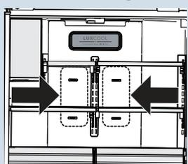
24 heures pour que la température se stabilise. Assurez-vous que les aliments ne bloquent pas les orifices de ventilation, car cela aura une incidence sur la température. Les aliments placés à moins de 1 pouce devant les orifices de ventilation d'air peuvent geler. Voir la rubrique COMMANDES ET RÉGLAGES dans votre Manuel d'utilisation et d'entretien.
