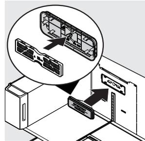
1. Placez les doigts sur le bas du couvercle du filtre à air et tirez du haut vers l'avant de l'appareil, libérant les boutons-pression supérieurs du couvercle du filtre à air de la tour d'air.
