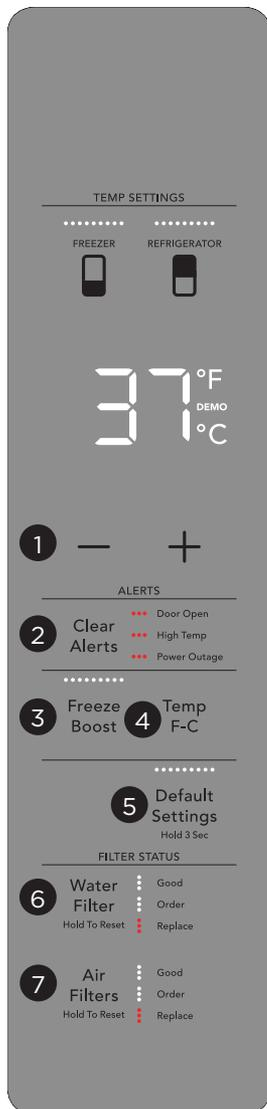
**1 Modifier la température** Sélectionnez le compartiment **FREEZER** (Congélateur) ou **REFRIGERATOR** (Réfrigérateur) pour modifier la température. Sélectionnez les boutons **+/-** pour régler la température
