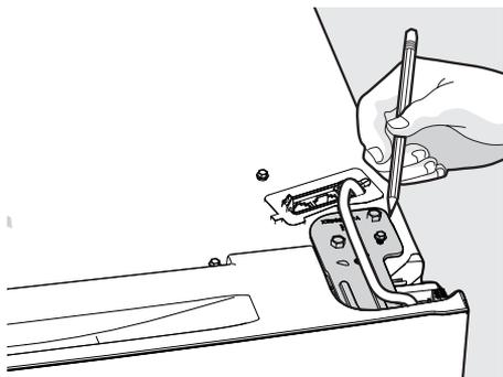
4. Retirez le couvercle de la cloison à l'arrière de l'appareil pour accéder au tuyau d'eau. Débranchez le tuyau d'eau de la conduite d'eau au niveau du raccord à verrouillage à l'arrière de l'appareil sous la cloison. La conduite du distributeur est raccordée à la conduite d'eau de couleur jaune provenant du robinet d'eau principal.
