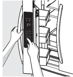
4. Continúe dispensando agua durante unos cuatro minutos para limpiar el sistema y las conexiones de las tuberías de cualquier impureza (deteniéndose para vaciar el vaso si es necesario).
