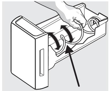
Ajuste de la barrena del contenedor de hielo
