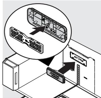
1. Coloque los dedos en la parte superior de la cubierta de aire y tire hacia el frente de la unidad. Los broches de presión superiores de la cubierta se liberarán de la torre de aire.
