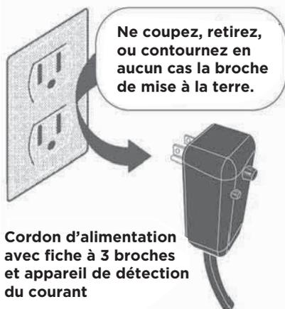
**Cordon d'alimentation avec fiche à 3 broches et appareil de détection du courant**
