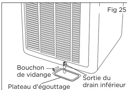
Remarque : Pour vous assurer que tout le condensé a été retiré, inclinez l'appareil en le soulevant légèrement vers le haut jusqu'à ce que le condensé ne s'écoule plus de la sortie.
