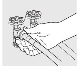
5. Utilizando los alicates, apriete 2/3 de giro adicionales cada conexión de suministro. **NO doble, retuerza ni comprima las mangueras de entrada de agua.**
