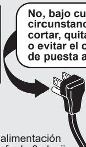
Cable de alimentación con Enchufe de 3 clavijas
