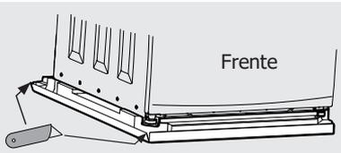
3. Con la ayuda de una segunda persona, con cuidado, incline ligeramente hacia la izquierda el centro de lavado tal y como ilustra en la imagen siguiente. Retire el soporte de transporte de espuma de la base de la unidad. Guarde la espuma de embalaje para uso futuro.
