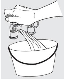
2. Compruebe si las mangueras de entrada tienen la arandela de caucho firmemente asegurada. Solo utilice mangueras nuevas.
