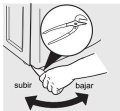
3. Haga presión alternando las esquinas y los lados y cerciórese de que no haya ningún movimiento. Ajuste las patas según sea necesario de manera que el centro de lavado quede firmemente asentado sobre el suelo en TODAS las cuatro patas. Mantenga la extensión de las patas de nivelación a un mínimo para optimizar el desempeño de la lavadora.
