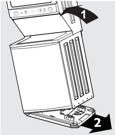
4. Baje con cuidado el centro de lavado hasta que quede en posición vertical y despegue la cinta que mantiene cerrada la tapa. Extraiga el bloque inmovilizador de espuma de la tina, todos los insertos de espuma y las otras piezas contenidas en la tina.
