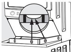
2. Use unos alicates ajustables para regular las patas de nivelación de manera que el centro de lavado quede nivelado del frente hacia atrás y hacia los lados y estable de esquina a esquina.
