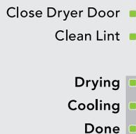
El LED **Clean Lint** se enciende después de cada ciclo de secado como un recordatorio para limpiar el filtro para pelusa. **El filtro para pelusa debe limpiarse después de cada carga.** Esta NO es una advertencia de que el conducto o el filtro del escape está obstruido. Abra la puerta o presione **CANCEL** para apagar el LED.
