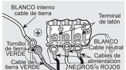
7. Traslade el cable de tierra interna (BLANCO) del mazo de cables de la secadora al bloque de terminales y asegúrelo junto con el conductor del cable de neutro del cable de alimentación (BLANCO) en el centro, terminal de color PLATEADO del bloque de terminales. Apriete firmemente el tornillo.
