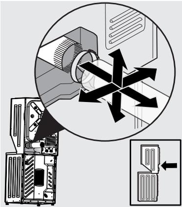
Una campana de escape que debe alinearse con el escape de la secadora puede instalarse directamente a través de la pared externa. Para expeler hacia los lados o hacia abajo, agregue un trozo de 8 pulgadas (20.3 cm) de longitud de conducto estándar de 4 pulgadas (102 mm) de diámetro y un codo de 90°.
