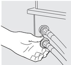
Apriete con la mano hasta que la conexión quede asegurada. Posteriormente, utilizando los alicates, apriete 2/3 de giro adicionales cada conexión de suministro.
