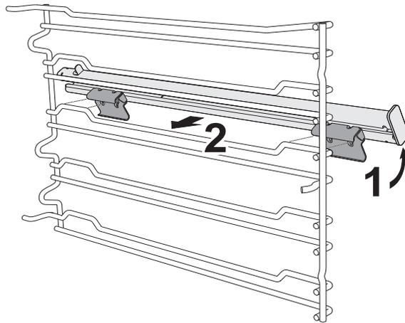
2. Tournez les guides pour verrouiller la partie inférieure du crochet sur la partie inférieure du support de plaque.
