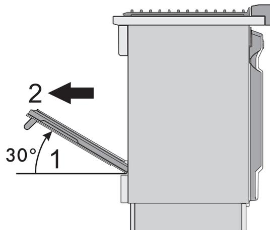
3. Pour remonter la porte, introduisez les charnières dans les fentes prévues à cet effet sur le four en vous assurant que les rainures **A** soient complètement posées contre les fentes. Abaisser la porte puis, après l'avoir positionnée, sortir les pivots des trous des charnières.
