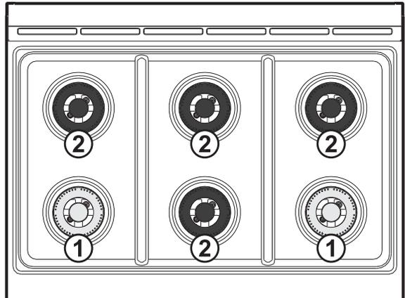
La plaque de cuisson est équipée de brûleurs avec deux revêtements différents, qui doivent être placés dans leur logement respectif correct :
