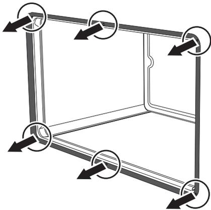
Le joint doit être souple et élastique. Pour garder les joints propres, utilisez une éponge non abrasive et de l'eau tiède.
